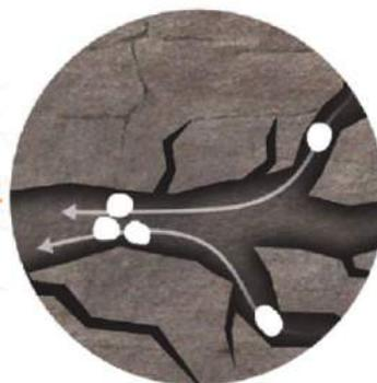
les fluides sont récupérés et les fractures sont maintenues ouvertes par un agent de soutènement, généralement constitué de sable ou de céramique
