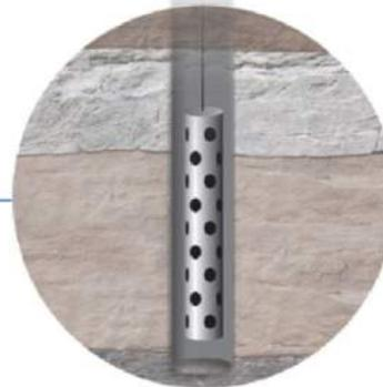
un dispositif de perforation est descendu à l'intérieur du tubage
