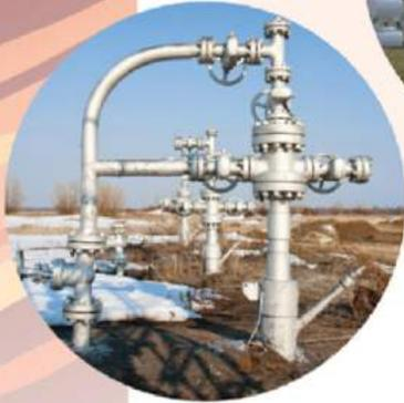
Normalement, la pression propre du gaz naturel est suffisante pour permettre sa circulation à travers le puits jusqu'à la surface, tandis qu'un système de vannes contrôle le débit.
