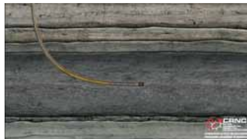
Image n° 2 : Forage d'un puits horizontal
